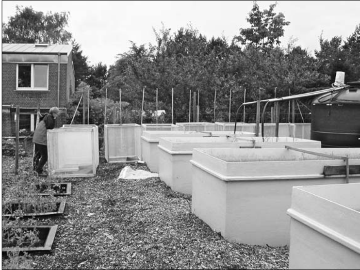
Abb. 2: Versuchsanlage mit Tidebecken und Flachbecken, August 2001 (Foto: J. Neubecker)
